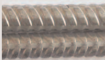
→ Exemple de produit cranté à froid.
