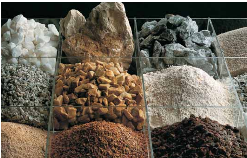
Exemple de granulats
