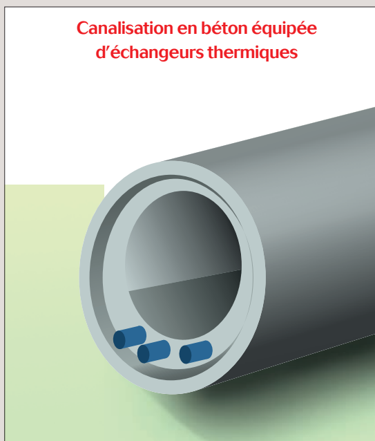
Système de récupération de la chaleur des eaux usées et transfert aux bâtiments via une pompe à chaleur
