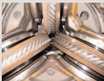
→ Cage de laminage avec trois galets de crantage pour la réalisation de verrous.
